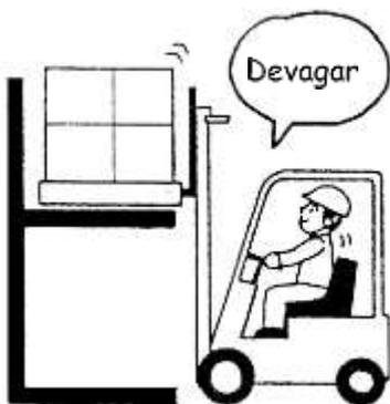
• Opere as alavancas de controle hidráulico lentamente ao carregar e descarregar. Há o risco de cair carga ou capotamento ao operar as alavancas de repente em posição de alta altura de garfos.
