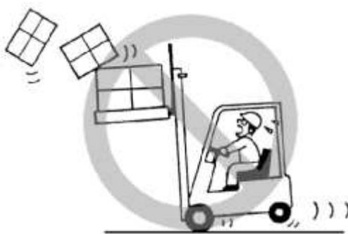
(5) Proibição do trabalho de com carga nas pontas do garfo ou utilizando essas.
