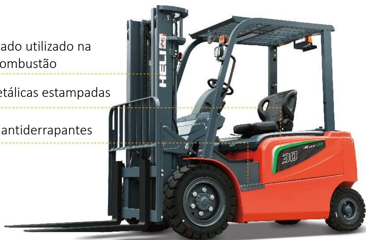
Eixo tração: Sistema de freio integrado, corpo fundido, retentores de óleo nos semieixo, engrenagens com alta precisão
