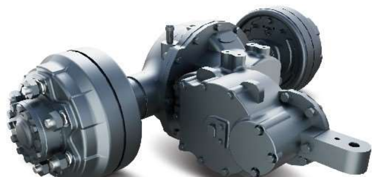
Eixo tração: Sistema de freio integrado, corpo fundido, retentores de óleo nos semieixo, engrenagens com alta precisão
