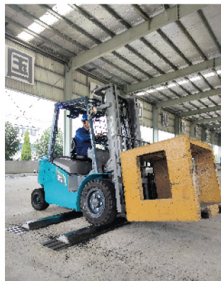
O caminhão passou no experimento de simulação de estrada esburacada.
