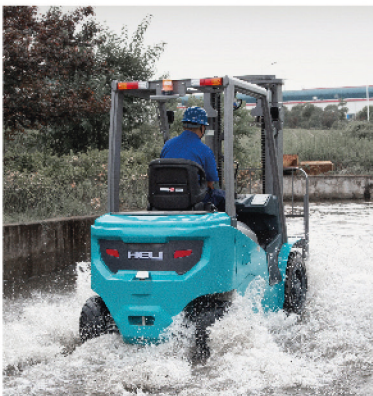
Após 10 minutos de travessia, o veículo não apresenta falhas. (Profundidade da água 200 mm)
