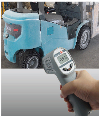
Todo o veículo pode ser operado alternadamente em câmara fria de -20°C por 6 horas e estacionado em câmara fria por 12 sem
