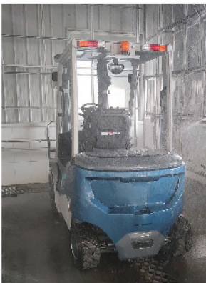
IPX3 à prova d'água: o veículo é ligado para simular um teste de chuva de 5000 L de curta duração de 15 minutos, e pode continuar a funcionar sem falhas
