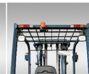
Sistema de iluminação em LED
