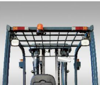
Sistema de iluminação em LED
